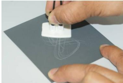
Рисунок 5.5 - Процесс шлифования торца оптоволоконна
